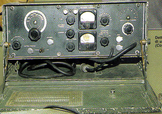
La SCR-694 sostituisce la 284 da quando è disponibile in quantità. Qui è montata su una jeep, alimentata da un convertitore PE-237, che è più voluminoso della radio stessa.
