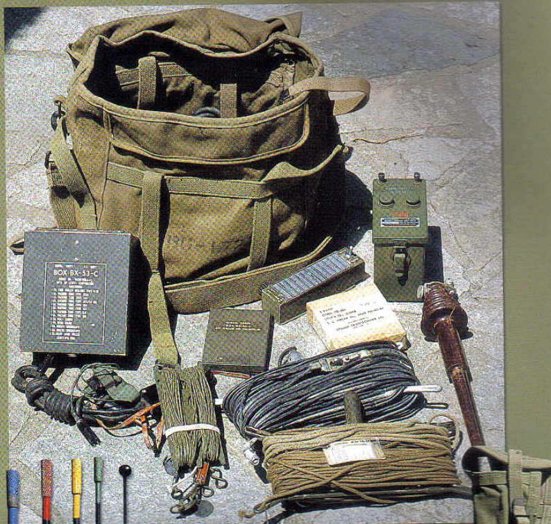
Lo zaino BG-172 contiene un insieme di accessori per la 284, tra cui diversi cavi e pezzi di ricambio, oltre ai cordoni dell'antenna. A destra una base di antenna IN-105 di celeron.
