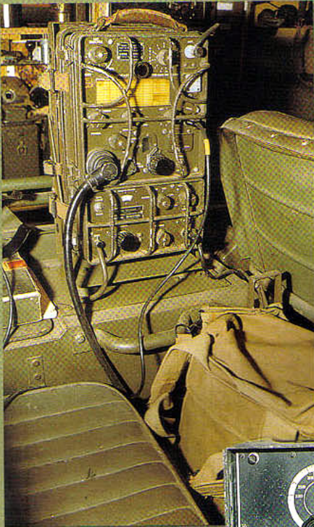
La SCR-694 sostituisce la 284 da quando è disponibile in quantità. Qui è montata su una jeep, alimentata da un convertitore PE-237, che è più voluminoso della radio stessa.
