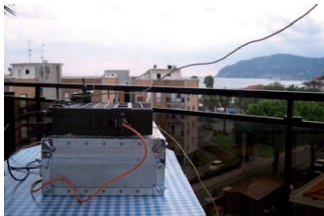
La long Wire. Notare il filo di terra tra il TRX e la parte metallica delle ringhiere
